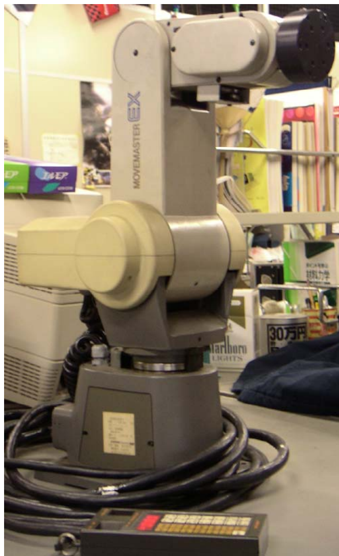
図 4-1 MOVEMASTER EX ロボットアームとティーチングボックス(下部コントローラ)
